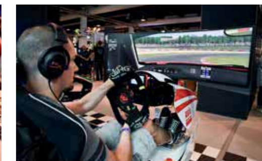
Im virtuellen Cockpit: Schalensitz, Butt-kicker-Feedback-System, Direct-Drive-Lenkradmotor sowie eine GFK-Verschulung. Die Racingfuel Academy in Horgen bietet ganzjähriges Training für alle im Simulator an.
